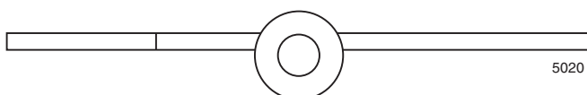
Gångjärn 5020 Storlek 4" x 1 1/2" Material: Obehandlat stål Förebild: Aug Stenman Nr 220 Varianter: Höger och vänster (H visas)
